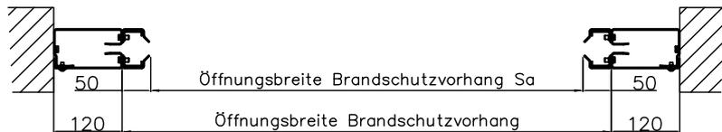
Maximale Größe Sa:  $2 \times \text{Nettohöhe} + \text{Nettbreite} < 18.000 \text{ mm}$
